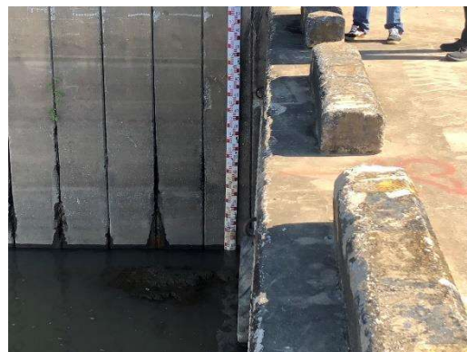
รูปที่ 4 การตรวจสอบระดับน้ำจากบรรทัดวัดระดับน้ำ
