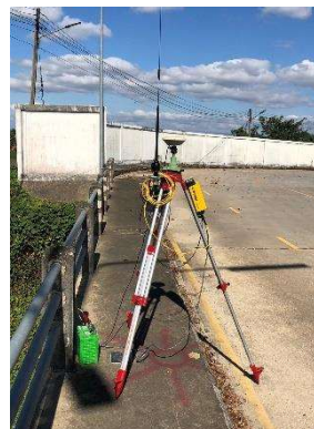
รูปที่ 6 ตรวจสอบความถูกต้องของเครื่องรับสัญญาณดาวเทียม
