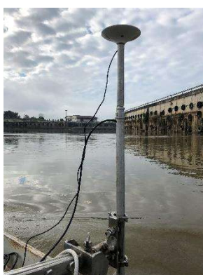
รูปที่ 5 ตรวจสอบติดตั้งเครื่องมือสำรวจ
